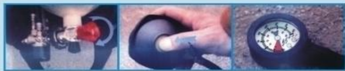
2 关闭气瓶（顺时针关，不要太紧），缓慢按下供气阀上黄色按钮同时观测压力表下降到5MPa处，报警哨是否报警
