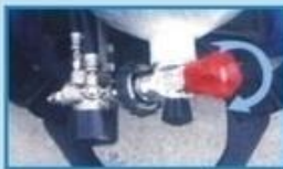
15 按下供气阀上黄色按钮，将余气全部放掉（必须做），直至压力表指针归零
