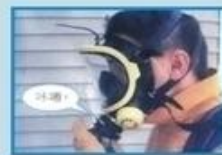
10 将供气阀插入面罩口（听到啾啾一声即可）
